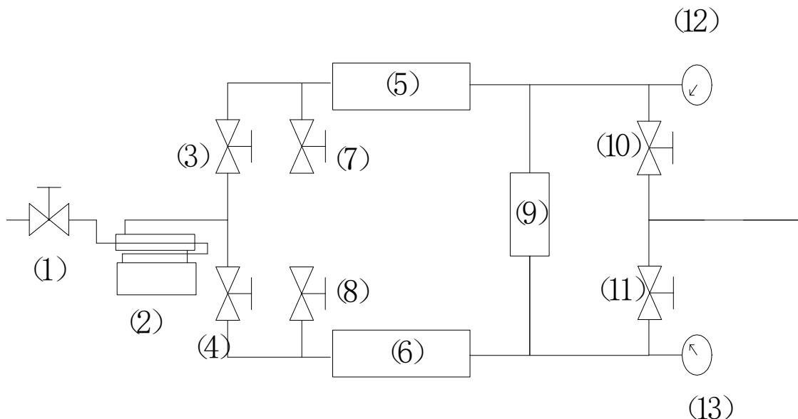
(1) 原气进阀、(2) 催化塔、(3) I 塔工作进阀、(4) II 塔工作进阀、(5) I 吸附塔、(6) II 吸附塔、(7) I 吸附塔放空阀、(8) II 吸附塔放空阀、(9) 再生气体给定器、(10) I 纯气出阀、(11) II 纯气出阀、(12) I 塔压力表、(13) II 塔压力表。
